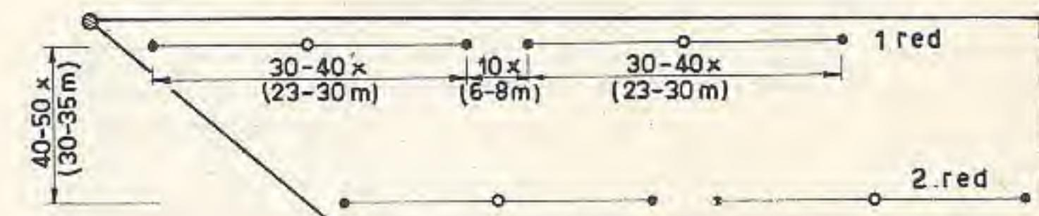
Sl. 29 — Način raspoređivanja protivpešadijskih poteznih mina kada su za jednu minu vezane po dve žice za potezanje
